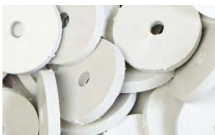
werden. Der Einsatz von Gewindeinsätzen ist ebenso möglich wie das Gewindeschneiden. Das Verkleben von PTFE ist jedoch erst nach der Oberflächenbehandlung mit speziellen Ätzmitteln möglich.
